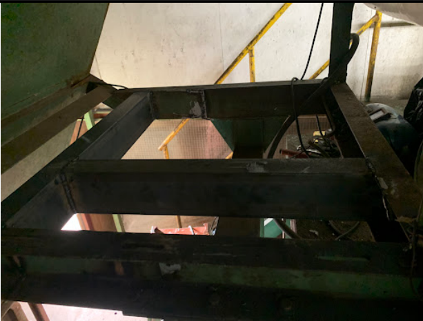
モーターを置く台を補修中
