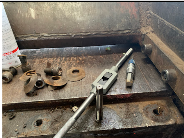
新しい刃板を取り付ける前に、タップにて手直し
