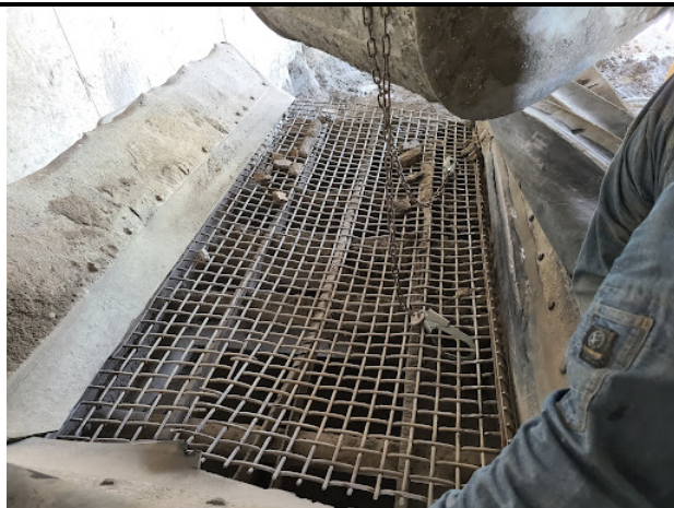
交換中1 サイドのクランピングバーを外し、網を取り外す。
