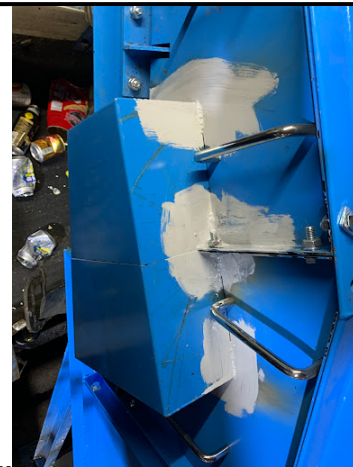
溶接した箇所にはサビ止め処理
