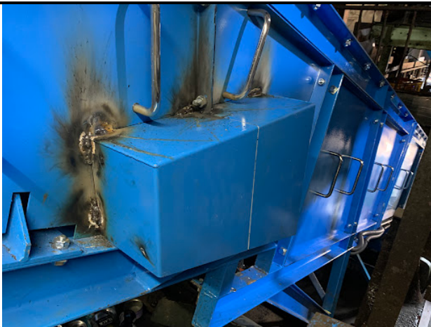
ヘッド側 ベアリング周りにもカバー取付け
