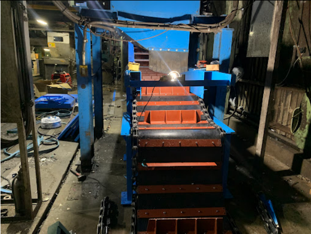
新規のベルト付きパンを引込み作業中
